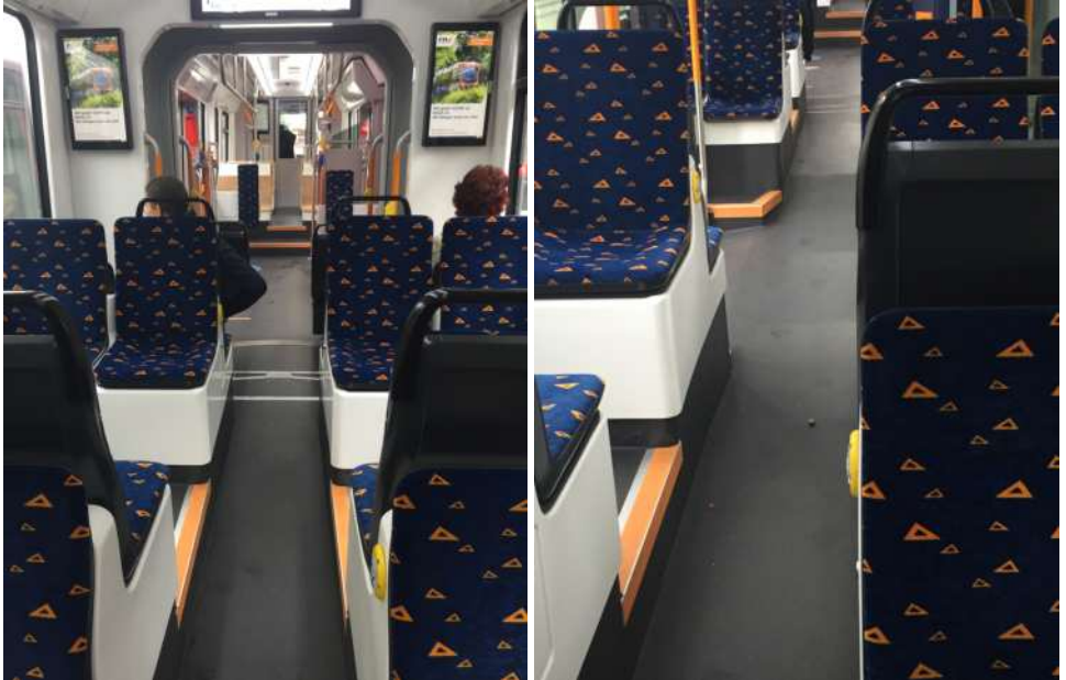
Innenraum einer Skoda-Bahn in Mannheim: Die Sitze sind nur über eine „Stolperstufe“ erreichbar, erkennbar an der orangefarbenen Markierung. Zwei Stufen führen zu dem erhöhten Bereich an den Wagenenden – auch orange markiert. Der Innenraum ist an den Faltenbälgen stark eingeschränkt.
