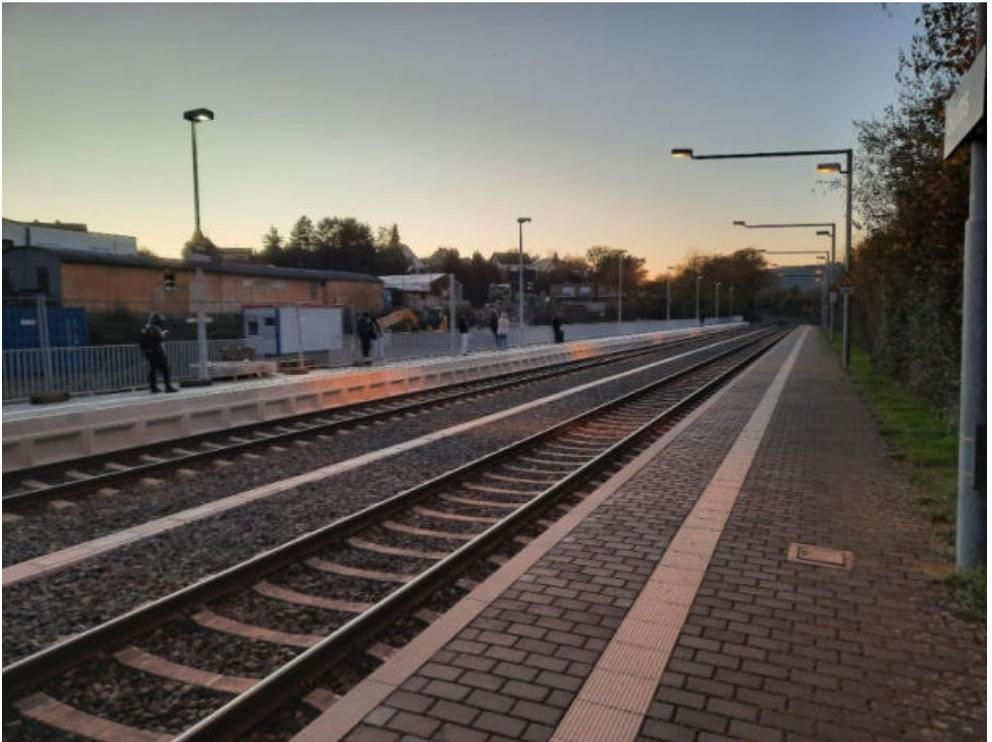
*Rechts der Bahnsteig an Gleis 1. Das Pflaster müsste nur herausgenommen und um 17 cm angehoben werden. Gegenüberliegend ist der neue Bahnsteig an Gleis 2 zu sehen. Früher war der Bahnsteig für Gleis 2 in der Mitte zwischen den Gleisen. Die Beleuchtung an dem alten Bahnsteig deutet noch darauf hin.*
