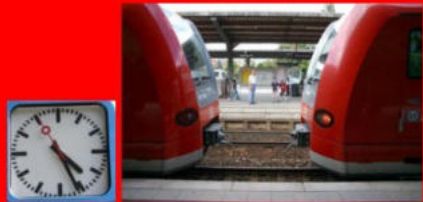
Verstärkungseinheit setzt sich in Bewegung / Halt der Rangierfahrt 1 m vor besetzter Einheit; Kupplungsfahrt
