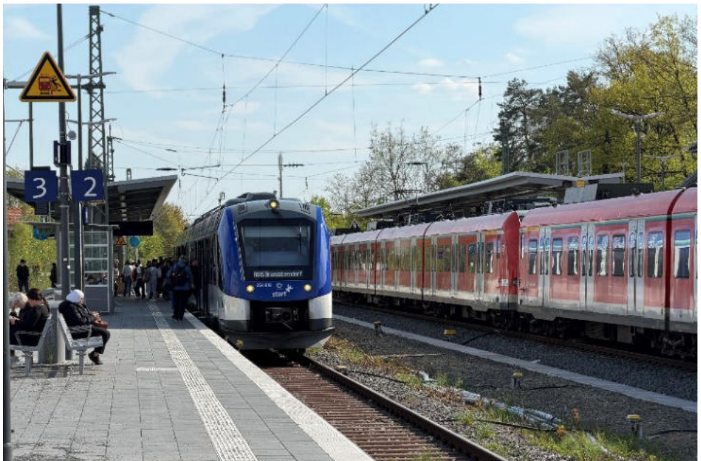
Abb. 2 Umsteigebahnhof Friedrichsdorf mit den Gleisen 11 (Kopfgleis), 1, 2, und 3, zum Teil schon ausgerüstet mit Deckungssignalen zum Vereinigen von Zügen
